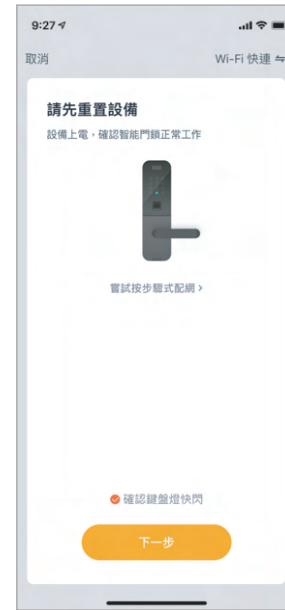
回到手機的 APP 操作界面直接勾選下方的“確認鍵盤燈快閃”並點選“下一步”即可開始連線
